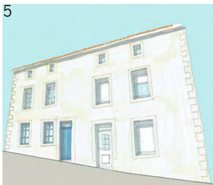
Le remplacement des menuiseries à droite : menuiseries PVC et volets roulants
