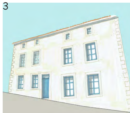
Le remplacement des menuiseries à gauche : menuiseries PVC et volets roulants
