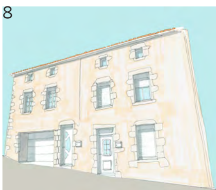
La réalisation d'un enduit ciment peint en surépaisseur et mise à nu des pierres d'encadrement de manière aléatoire
